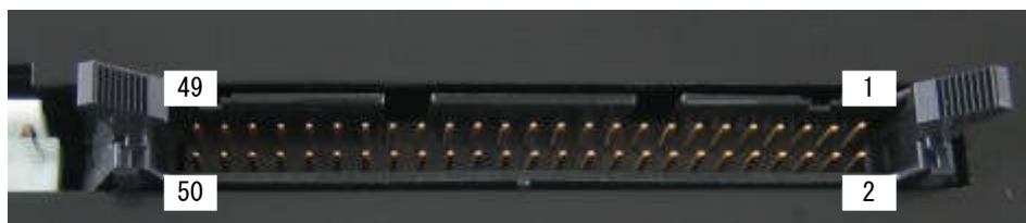
図 2-9 50Pコネクタピン配置
